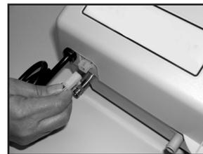
3. Débrancher les câbles de contrôle de l'humidificateur en attrapant fermement les capuchons de connexion en nylon puis en tirant dessus.
