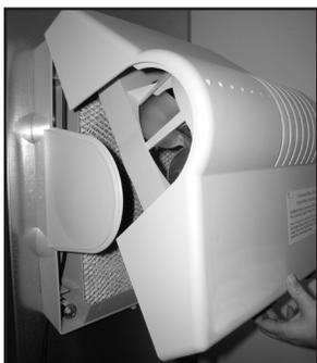
9. Vuelva a colocar la tapa, enganchándola en la parte superior del marco de montaje, y luego asegurándola con el tornillo de pulgar en la parte inferior, girándolo en sentido de las manecillas del reloj (↻).
