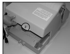
4. Retirer le couvercle de l'humidificateur du cadre de montage en faisant tourner la vis à serrage à main (encrélé) dans le sens contraire des aiguilles d'une montre (↺). Faire basculer le couvercle puis le retirer.
