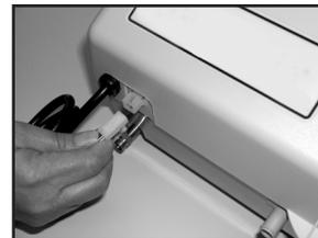
3. Desconecte los cables del control del humidificador, tirando firmemente del conector de nilón en sentido recto hacia afuera.
