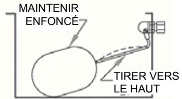
**Figure 7-B** – Abaissement du niveau d'eau
